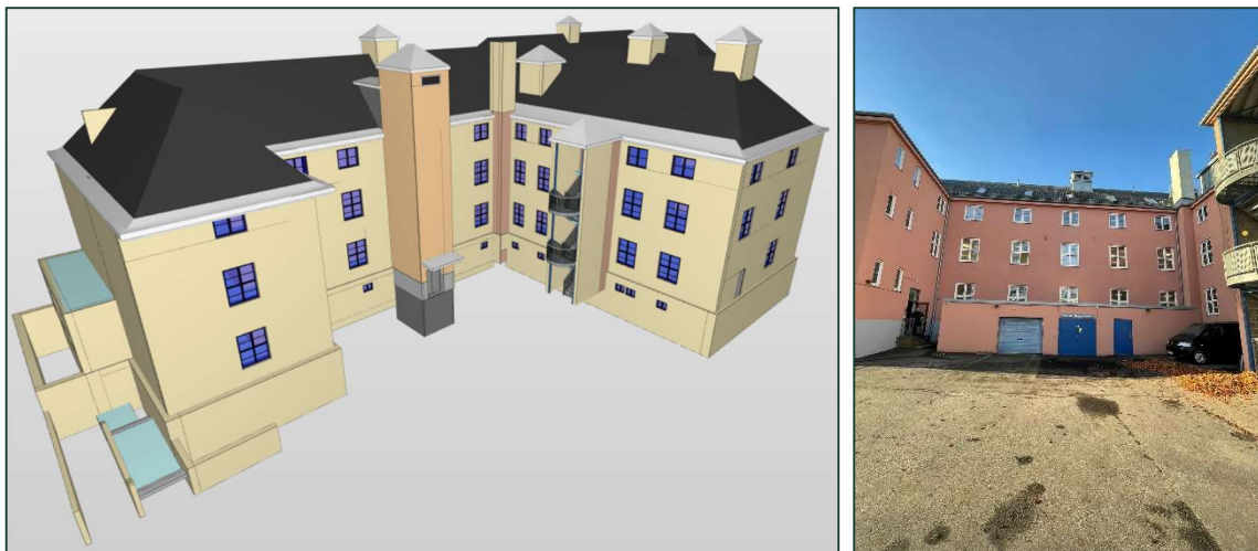
Figur 1: IFC-modell med planlagt heissjakt (venstre) og foto av fasade (høyre)..
